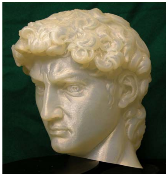
Figura 14. Un esempio di riproduzione materica ottenuta dal modello digitale 3D (tecnologia di riproduzione per "stereolitografia").
