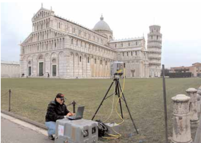
Il rilievo del paramento esterno del Duomo è stato eseguito in pochi giorni dal DIAPReM di Ferrara con il supporto del Dipartimento di Progettazione dell'Architettura di Firenze. Sono state applicate procedure integrate topografiche e laser scanner 3D (11 stazioni per circa 88.800.000 punti con il Leica HDS 2500 e 11 stazioni per circa 115.200.000 punti realizzati con il Leica HDS 3000). L'acquisizione è avvenuta definendo una densità di maglia di circa 1 cm con infittimenti su particolari decorativi o strutturali della facciata e dell'abside con maglia di dettaglio di circa 6 mm. È stata realizzata: una scansione di tutto il monumento dai vari punti di osservazione compreso i punti accessibili dall'alto; un'ottimizzazione tramite rilievo topografico realizzato con stazione totale integrata Reflectorless Leica TCR1101 XR; una registrazione di tutte le scansioni con georeferenziazione.
