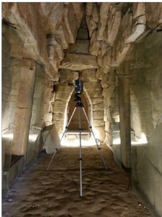
Fig. 2 – Sesto Fiorentino (FI), tumulo della Montagnola. Un momento durante il rilievo laser scanner dell'interno della tomba.
